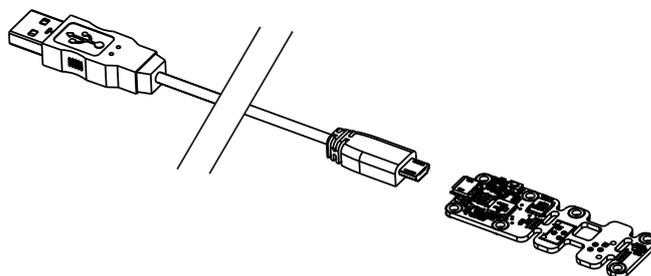
Vous devez raccorder votre module Yocto-Temperature à l'aide d'un câble USB 2.0 de type A - micro B
