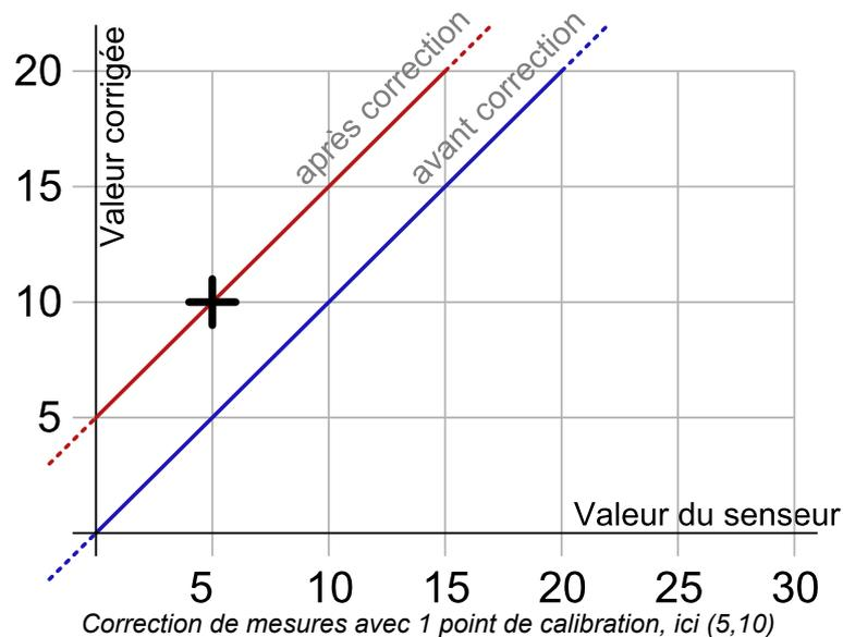
La mise en pratique est des plus simples: il suffit d'appeler la méthode `calibrateFromPoints()` de la fonction que l'on désire corriger. Le code suivant applique la correction illustrée sur le graphique ci-dessus à la première fonction `temperature` trouvée. Notez l'appel à la méthode `saveToFlash` du
