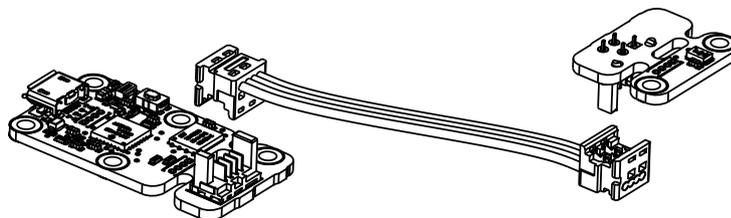
*Déport du capteur à l'aide de connecteur PicoFlex.*
