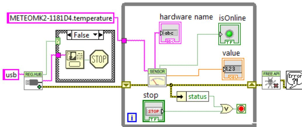
Le message d'erreur le plus courant est "Another process is already using yAPI". Il signifie qu'une autre application, LabVIEW ou autre, utilise déjà l'API en module USB natif. En effet, pour des raisons techniques, l'API USB native ne peut être utilisée que par une seule application à la fois sur la même machine. Cette limitation peut être facilement contournée en utilisant le mode réseau.
