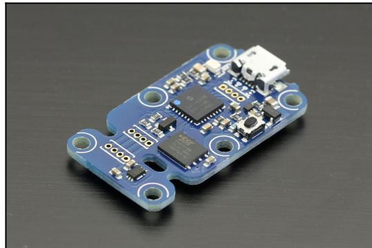
Le module Yocto-Light-V3 est équipé d'un capteur de lumière (luxmètre) qui vous permettra de mesurer la lumière ambiante jusqu'à 100'000 lux. Ce module permet de faire des mesures instantanées de lumière via USB, mais aussi d'enregistrer les mesures sur une mémoire flash intégrée et de les relire ultérieurement via USB.
