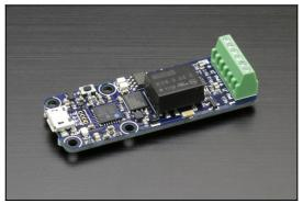
Le Yocto-PWM-Rx est un décodeur de signaux PWM. Pour chacun de ses deux canaux, il pourra vous indiquer la fréquence, le duty cycle et la longueur des impulsions. Il fonctionne de 0.05Hz à 250kHz et accepte n'importe quel signal entre -30 et + 30V pour autant qu'il franchise le seuil de 0.7 V.
