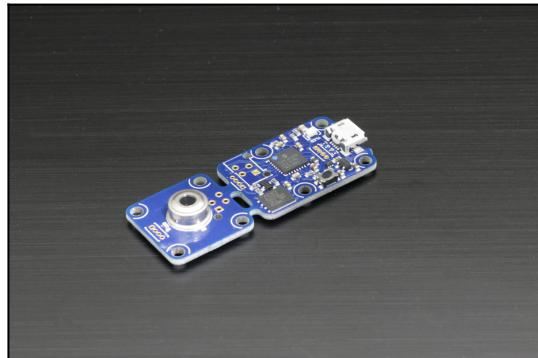
Le module Yocto-Temperature-IR est un capteur de température USB basé sur une mesure infra-rouge. Il permet d'effectuer des mesures instantanées de température via USB, ainsi que d'enregistrer la température sur une mémoire flash intégrée et de les relire ultérieurement via USB.
