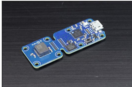
Si vous avez besoin de mesurer une inclinaison avec précision, le Yocto-Inclinometer est la solution. Ce module USB, basé sur le capteur SCL3300 de Murata, dispose d'un accéléromètres 3D suffisamment précis pour permettre de mesurer une inclinaison sur deux axes avec une précision de 0.01°. Attention, Ce module ne contient pas de boussole, vous pouvez connaître son inclinaison par rapport à la verticale mais pas son orientation horizontale.
