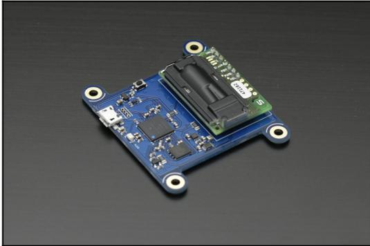
Le module Yocto-CO2-V2 permet d'effectuer par USB des mesures instantanées de teneur en CO2 de l'air ambiant. Il mesure aussi le taux d'humidité relative, la température et la pression atmosphérique. Il permet d'enregistrer les mesures sur une mémoire flash intégrée et de les relire ultérieurement via USB.
