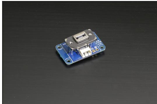
Le Mini-Battery-Supervisor est un minuscule circuit qui permet d'alimenter par batteries des appareils électroniques à faible consommation qui sont normalement prévus pour être alimentés par USB, tout en maintenant la possibilité de s'y connecter par un câble USB lorsque c'est nécessaire.
