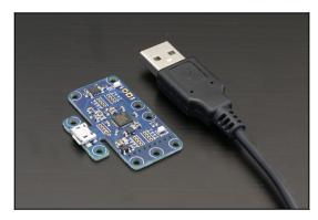
Ce module est un hub USB 2.0. C'est un hub multi-TT qui offre de meilleures performances qu'un simple hub single-TT lorsque plusieurs périphériques USB 1.1 lui sont connectés. Un de ses points forts est sa taille minuscule: il fait 42x28mm et ses dimensions peuvent même être ramenées à 36x20mm en coupant certaines parties du board.
