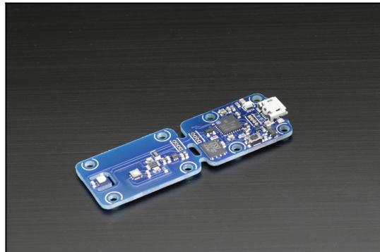
Le module Yocto-VOC-V3 permet d'effectuer par USB des évaluations instantanées de teneur en COV dans l'air ambiant, en équivalents CO<sub>2</sub> ou en TVOC. Il mesure simultanément la température ambiante et l'humidité dans l'air. Il permet aussi d'enregistrer les mesures sur une mémoire flash intégrée et de les relire ultérieurement via USB.
