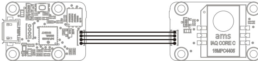
Câblage des sous modules une fois ceux-ci séparés.
