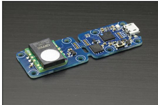
Le module Yocto-VOC-V2 permet d'effectuer par USB des évaluations instantanées de teneur en COV dans l'air ambiant. Il permet aussi d'enregistrer les mesures sur une mémoire flash intégrée et de les relire ultérieurement via USB.
