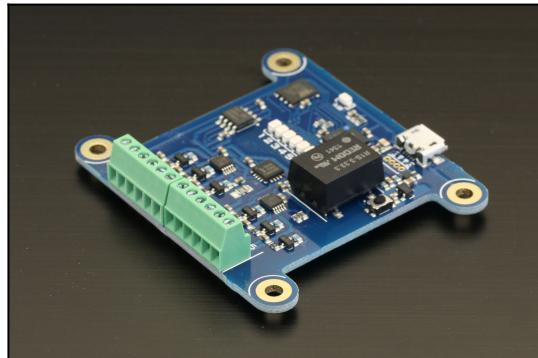
Le module Yocto-MaxiThermistor est une interface USB permettant de lire jusqu'à six points de température mesurés au moyen de thermistors NTC ou PTC. Chaque canal peut être configuré indépendamment au moyen d'une table ou encore d'une température de référence et d'un coefficient  $\beta$ . Le Yocto-MaxiThermistor est un module isolé: la partie mesure est électriquement isolée de la partie USB.
