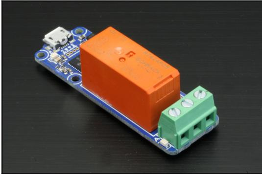
Le module Yocto-LatchedRelay contient un relais bistable à commutation piloté par USB: vous pouvez diriger par logiciel l'entrée du relais vers l'une ou l'autre des deux sorties. Pour faciliter le développement, une LED disposée vers chacune des sorties vous indique laquelle est active.
