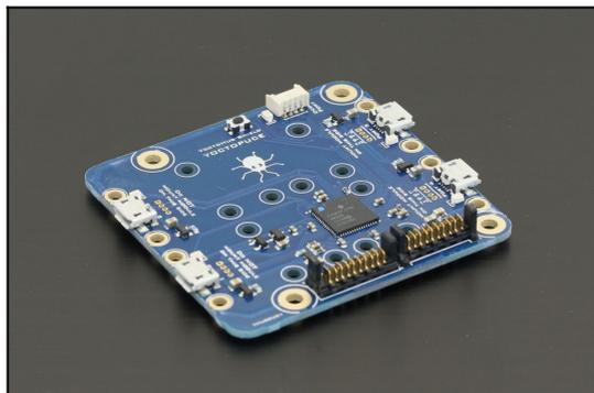
Si vous avez besoin de brancher plus que 3 modules Yoctopuce sur l'un de nos hubs réseau, vous pouvez leur adjoindre ce board d'extension. Branché sur le hub réseau à l'aide d'une nappe Picoflex (incluse), il permet de raccorder 4 modules supplémentaires au réseau. Il ne demande pas de câble d'alimentation séparé car il est alimenté directement par le hub réseau à travers la nappe Picoflex.
