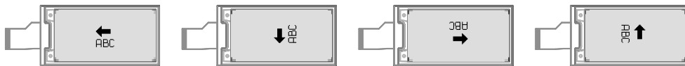
Effet des paramètres LEFT, UP, RIGHT et DOWN sur l'orientation de l'affichage.
