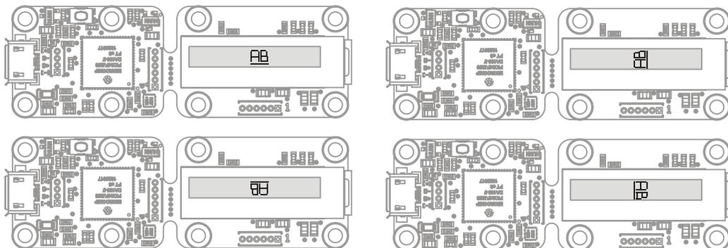
Effet des paramètres LEFT, UP, RIGHT et DOWN sur l'orientation de l'affichage.
