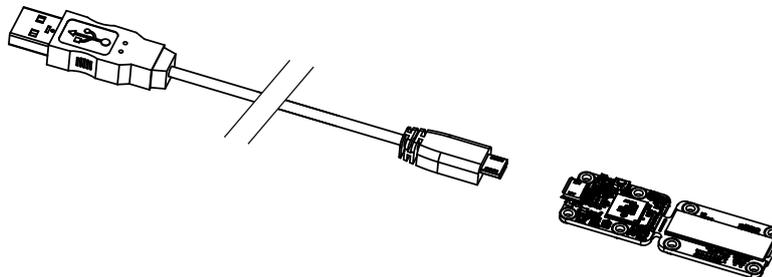
Vous devez raccorder votre module Yocto-MiniDisplay à l'aide d'un câble USB 2.0 de type A - micro B
