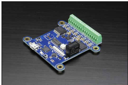
Le module Yocto-Maxi-IO-V2 fournit huit entrées/sorties digitales électriquement isolées du bus USB. Chaque bit d'entrée/sortie peut être configuré individuellement comme une entrée bipolaire, entrée open-drain (pull-up interne), sortie type TTL/CMOS ou sortie open-drain (collecteur ouvert).
