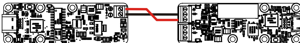
L'alimentation peut être fournie par le récepteur, ici un Yocto-4-20mA-Rx
