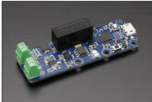
Le Yocto-0-10V-Tx est un module USB doté de deux canaux capables de générer des tensions entre 0 et 10V, par exemple pour piloter des drivers de LED ou des systèmes d'éclairage. Chaque canal peut fournir jusqu'à 20mA.
