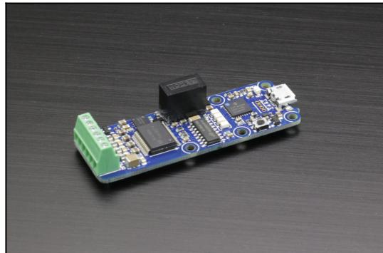
Le module Yocto-IO fournit quatre entrées/sorties digitales électriquement isolées du bus USB. Chaque bit d'entrée/sortie peut être configuré individuellement comme une entrée bipolaire, entrée open-drain (pull-up interne), sortie type TTL/CMOS ou sortie open-drain (collecteur ouvert).
