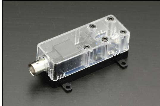
Le module Yocto-milliVolt-Rx-BNC est un voltmètre USB de précision qui permet de mesurer par USB des faibles tensions (de quelques dizaines de microVolts jusqu'à 2V maximum), même lorsqu'elles sont produites par des phénomènes physiques ou chimiques extrêmement faibles (signaux de très grande impédance). Le connecteur BNC permet le raccordement sur un câble coaxial blindé.
