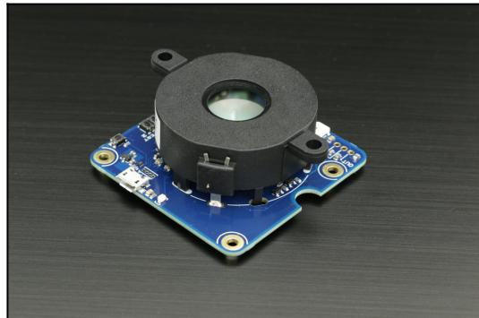
Ce module est essentiellement un puissant buzzer pilotable par USB. La fréquence et le volume sont contrôlables, il dispose même d'un système permettant de pré-programmer des petites mélodies simples.
