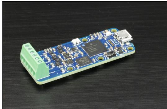
Ce module est un adaptateur USB pour interroger des périphériques sur un bus I2C. Si nécessaire, le module peut aussi fournir une petite source de tension configurable pour alimenter le circuit électronique à interfacer en 1.8V, 3.3V ou 5V. La communication I2C peut se faire en 1.8V ou 3.3V.
