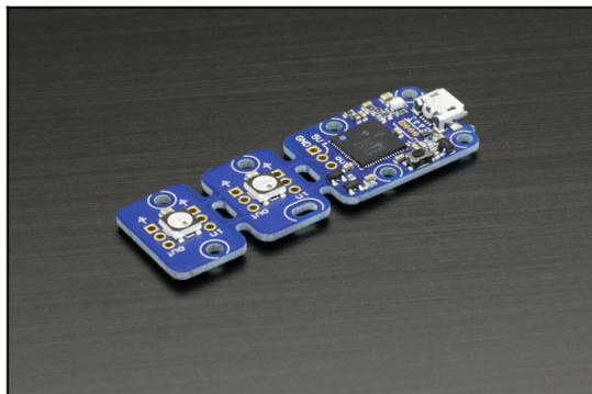
Ce module est une interface USB pour piloter des LEDs RGB par USB. Vous pouvez à tout moment changer la couleur et la luminosité de chacune de ses deux LEDs. Vous pouvez l'utiliser aussi bien pour signaler facilement l'état d'un automate, que pour fabriquer des effets lumineux spectaculaires.
