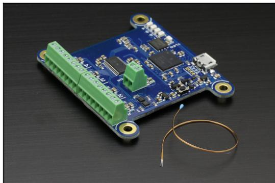
Le module Yocto-MaxiBridge est un convertisseur analogique/numérique ratiométrique de précision permettant de mesurer par USB les très faibles tensions produites par les cellules de charge utilisées pour fabriquer une balance, ou toute sorte de cellule de force ou capteur en pont de Wheatstone.
