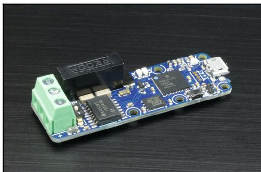
Ce module est un adaptateur USB vers RS485. Il ne nécessite pas de driver et n'installe pas de port COM virtuel.
