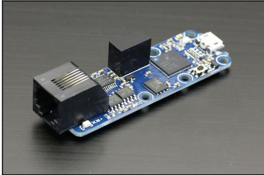
Ce module est un adaptateur USB vers RS232. Il ne nécessite pas de driver et n'installe pas de port COM virtuel.
